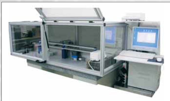
Realisiertes Handlingsystem für Kleinstmassen im BEV.
