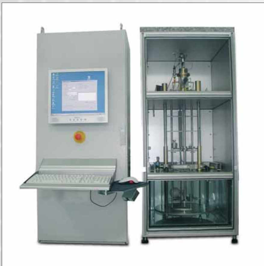
Abb. 1: Volumenkomparator VD1005: realisierte Anlage im BEV.
