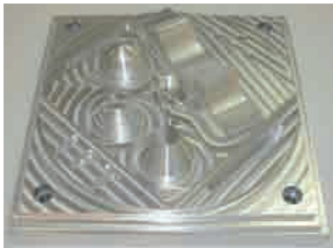
Fräsbahn unter GOelan.
