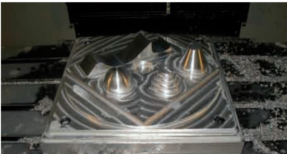
Das fertige Werkstück nach der Bearbeitung unter TopSolid.
